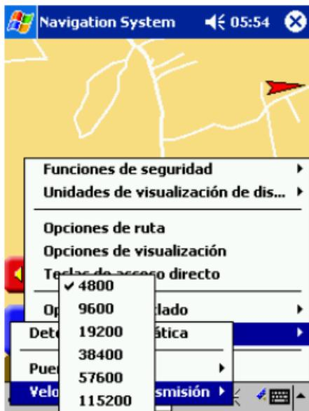
La Velocidad en Baudios (Baud Rate) debe configurarse en 4800
