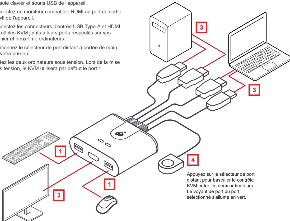
Appuyez sur le sélecteur de port distant pour basculer le contrôle KVM entre les deux ordinateurs. Le voyant de port du port sélectionné s'allume en vert.
